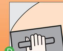
Pre zvýšenie pevnosti dosiek v tlaku nalepiť maliarsku a opravárenskú tkaninu pomocou špeciálneho lepidla GK10.
